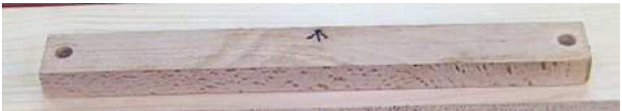
Die Bohrschablone markieren wir mit einem Richtungspfeil, um später beim bohren der Löcher immer den gleichen Abstand zu haben. Für die Holzdübel bohren wir 8mm Löcher in die Schablone, die später im Dach auf 8,5mm
