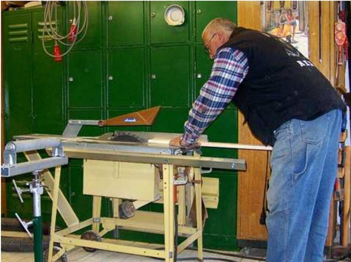
Nach dem Entfernen der Nuten und Federn werden die kantigen Bretter auf Länge geschnitten. Am einfachsten benutzt man eine Kappsäge mit Anschlag um sich ein immer neues Abmessen zu ersparen.
