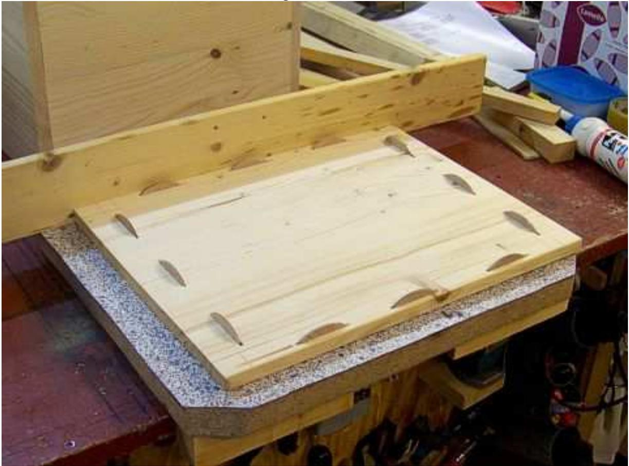
Leim auftragen und die Lamellos einfügen. Dann kann das Dach aufgesetzt werden.
