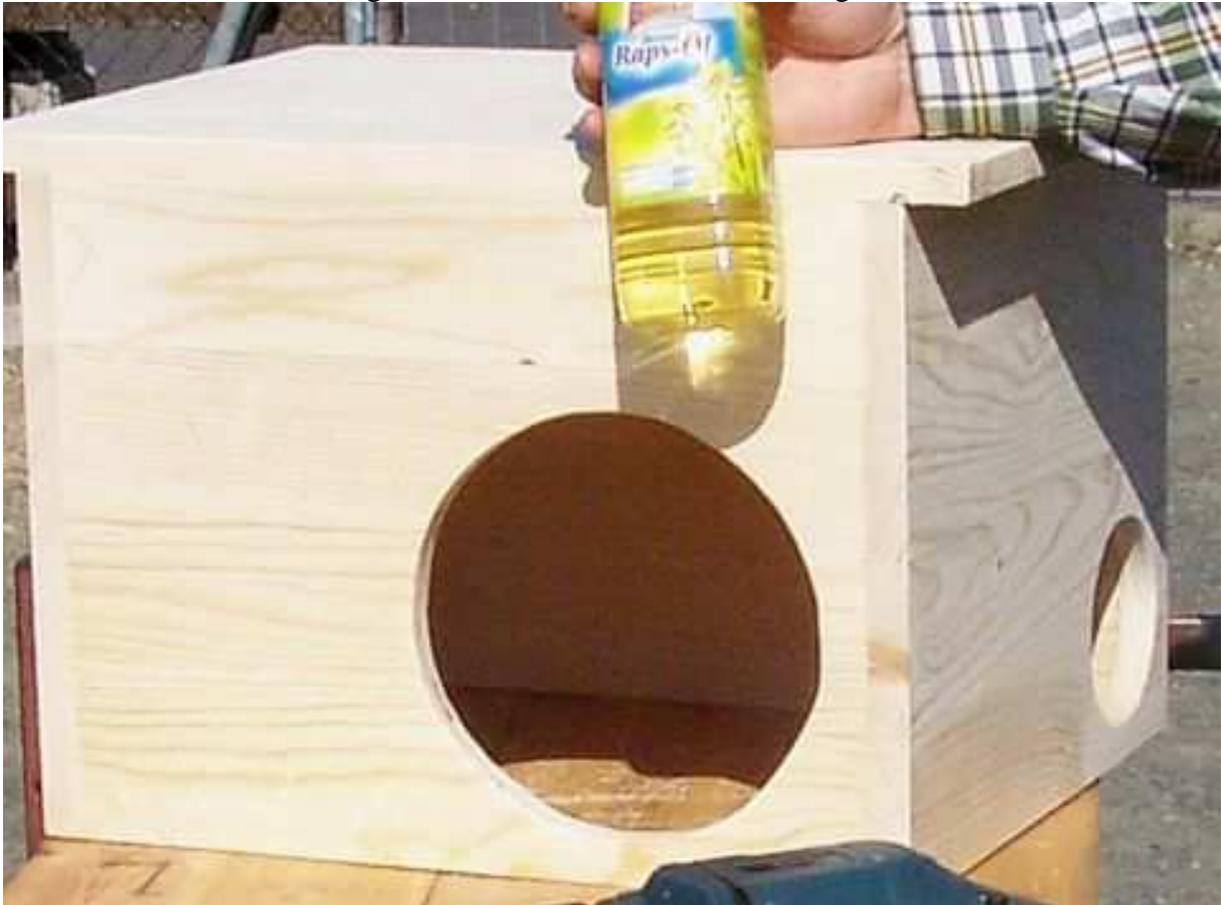
Vor dem Streichen kann man noch ein Bildchen einritzen oder einbrennen. Das Öl satt auftragen und nach cirka 15 Minuten mit einem Putzlappen oder Küchenpapier den Überschuss abwischen. Nun ist ein einfaches aber sehr haltbares Kaninchenhaus fertig.
