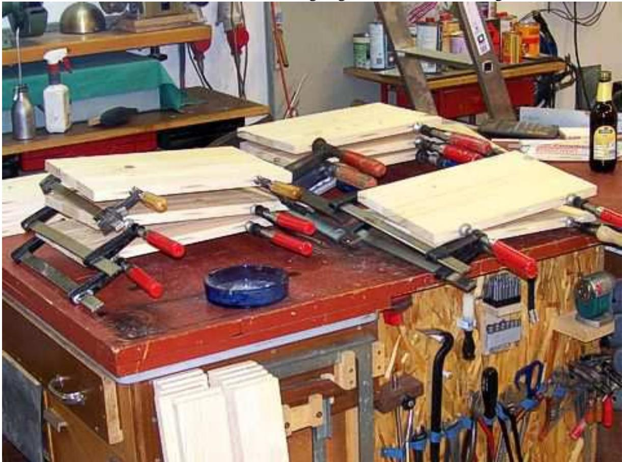
Nach ein paar Stunden können die Seitenteile mit Leim bestrichen und zusammengefügt werden. Das Ganze wird dann wieder mit Schraubzwingen verspannt.
