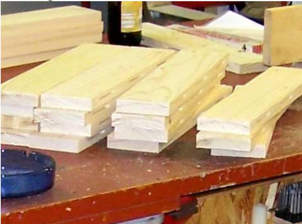
Nach dem Fräsen der Lamello- Nuten wird der Leim aufgetragen. Auf einer Seite komplett in Nute und auf der Fläche, auf der Gegenseite nur in den Nuten.
