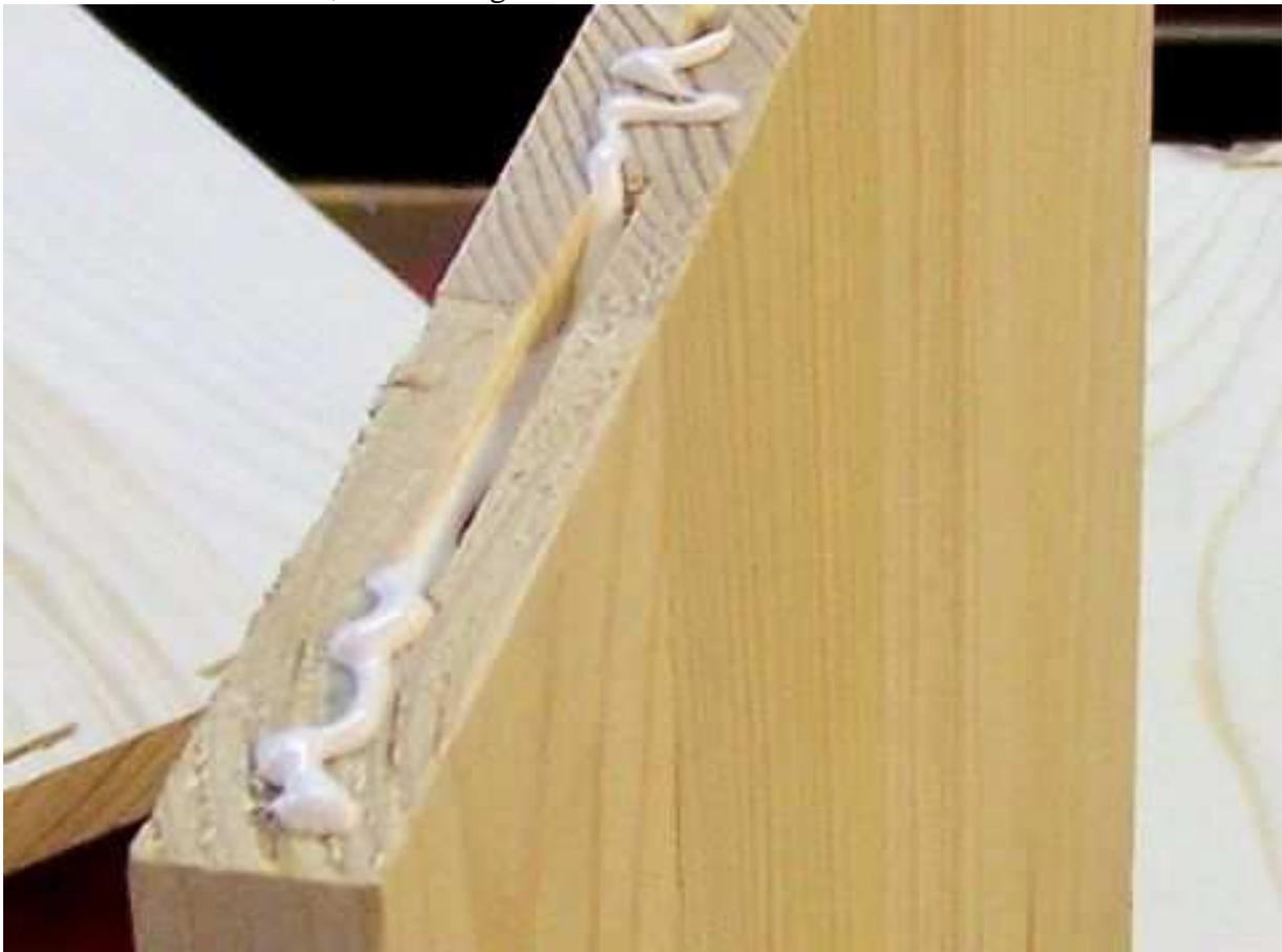
Lamellos sind aus hoch gepresstem Hartholz, die sich in Verbindung mit dem Leim ausdehnen. Nach dem Abtrocknen des Leimes ist eine sehr feste Verbindung der Hölzer gegeben. Es gibt sie in verschiedenen Größen, die je nach Holzstärke benutzt werden.
