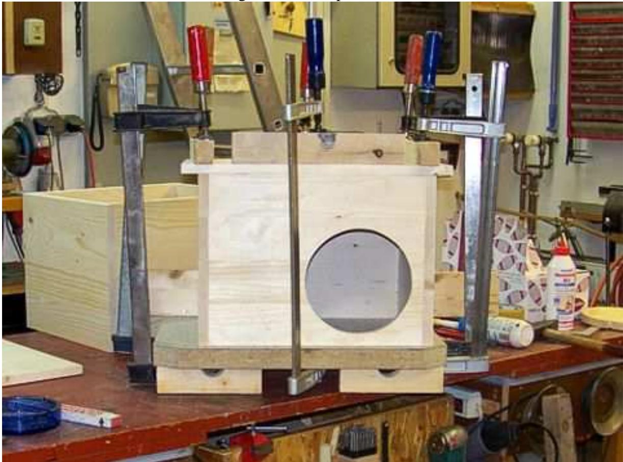
Nach dem Abtrocknen des Leimes (ca4 Stunden) wird das Kaninchenhaus geschliffen und alle Kanten etwas gebrochen.
